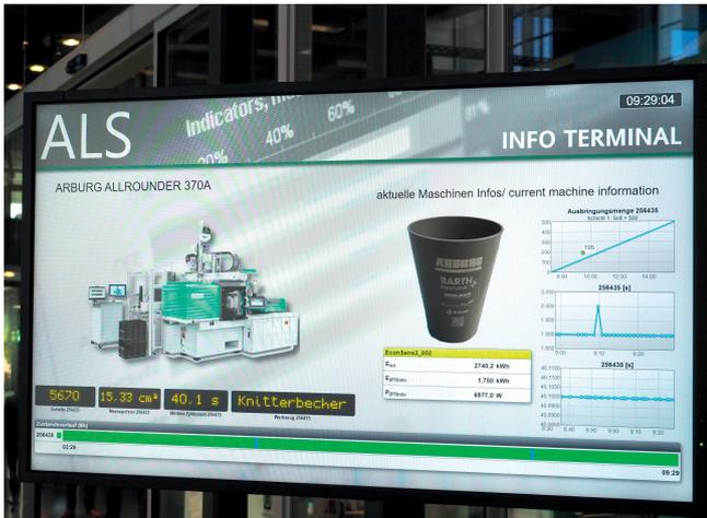
**Bild 1.** Zu den Kernaufgaben des Arburg Leitrechnersystem ALS zählt die Erfassung und Analyse der Produktionsdaten in Echtzeit. © Hanser / C. Doriat
